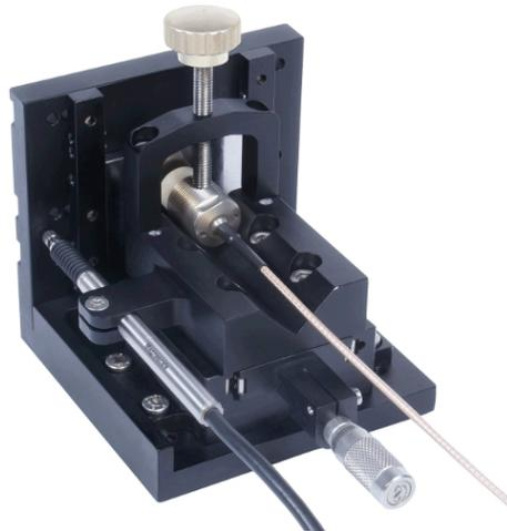
Abbildung 9: Tragbare Lineareinheit mit linearem Encoder von Magnescale, einem Wirbelstromsensor und einem Target mit den Dimensionen 50x50x5 mm.
